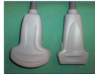
Abb. 1: Konvexer Schallkopf (3-5 MHz; links) und Linearschallkopf (10 MHz; rechts).
